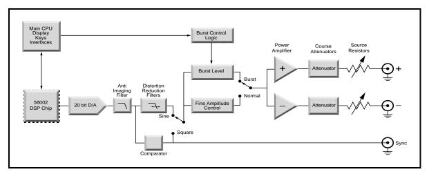
Figure 2-1 DS360 Block Diagram
